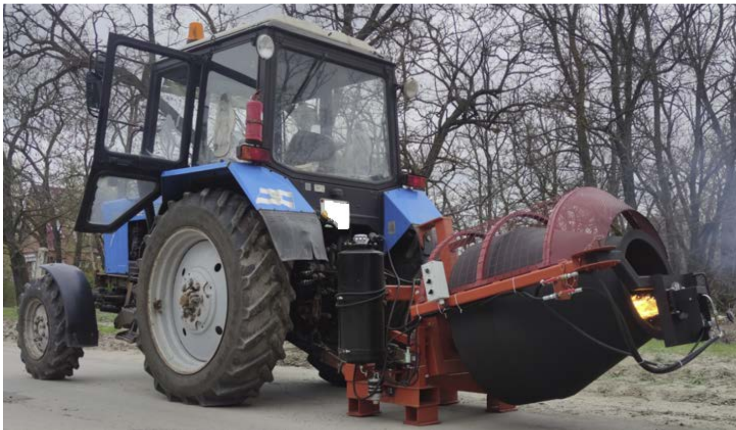
Рисунок 3 - Общий вид рециклера асфальтобетона типа ЕМ-350
