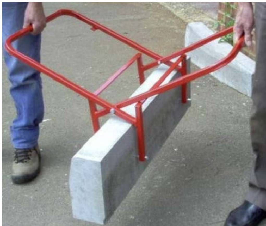
Рисунок 2.3 - Общий вид захвата-клещей
