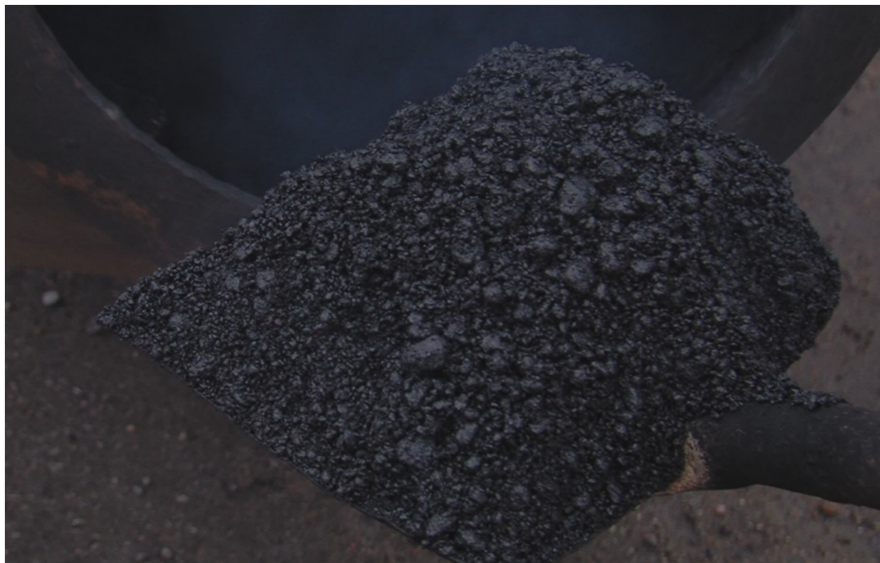
Рисунок 8 – Процесс приготовления регенерированной асфальтобетонной смеси
